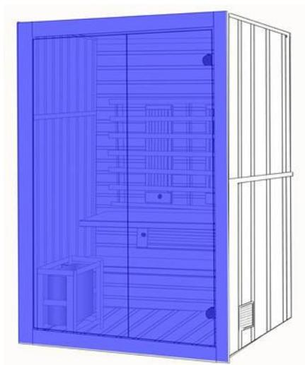
(9) Montare l'elemento anteriore sul lato sinistro. pannelli laterali installati.
