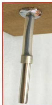
Assicurarsi che il sensore di temperatura sia circa A 2 cm di distanza dal tubo di silicone.
