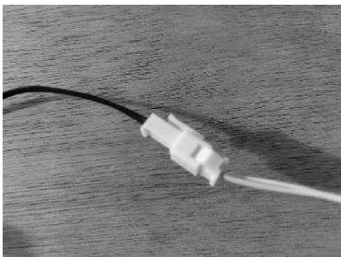
(3) Collegare il connettore del sensore di temperatura.
