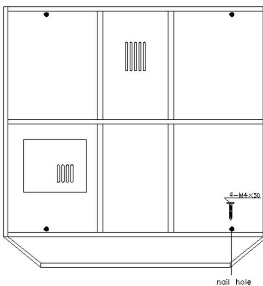
Installare il coperchio antipolvere con le viti sul tetto
